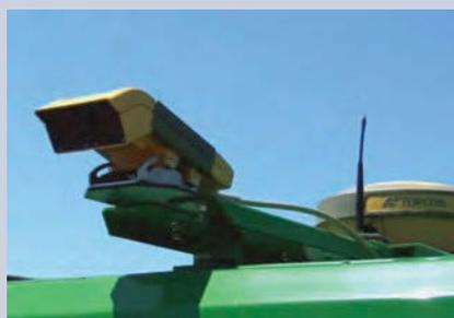
(TOPCON CropSpec) che, attraverso sensori multispettrali collocati sui mezzi agricoli, monitora le coltivazioni e permette di controllare l'irroratrice o lo spargiconcime e di applicare direttamente il prodotto a dose variabile in relazione alle necessità della coltivazione. Questo dispositivo consente di costruire in real time le mappe di prescrizione senza dover elaborare i dati in ufficio. Tutti i dati (confi-
